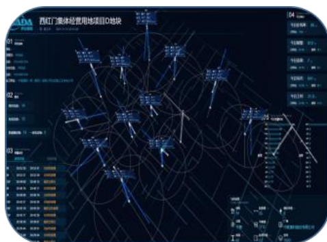
图 47 塔吊防碰撞系统
