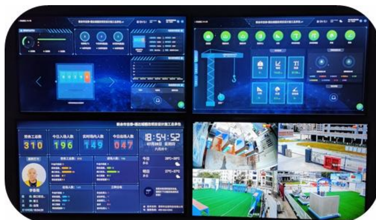
图 59 智慧工地监管平台
